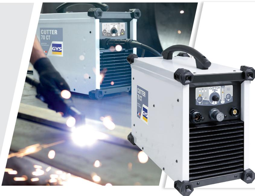
Le CUTTER 70 CT est un découpeur plasma de 70 A doté d'une **capacité de coupe de 35 mm** d'épaisseur sur une multitude de matériaux. Son système **d'amorçage sans HF** permet de préserver et d'accroître la durée de vie des consommables. Destiné à évoluer dans les environnements difficiles, il dispose d'une mécanique très **robuste** et d'un **panneau de commande intuitif**. Il est précablé pour une utilisation sur table automatique de découpe.
