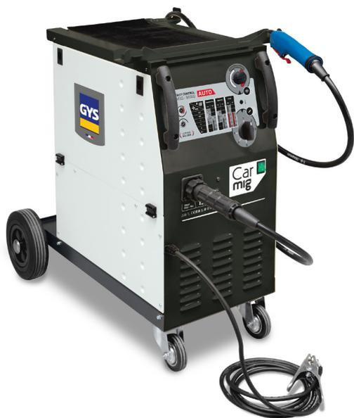
Idéal pour souder les tôles fines, il a été conçu pour réparer les voitures avec un courant minimum à seulement 15 A. L'interface SMART facilite les réglages, offrant un gain de temps considérable.
